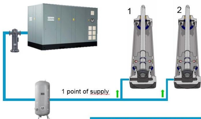
傳統空氣緩衝桶安裝位置
